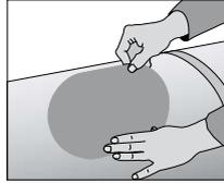
Nicht für Wickelfalzhöhre geeignet. Oberflächen müssen sauber und ohne Kratzer sein. Die selbstklebende Schablone auf die Rohrwand aufkleben.
